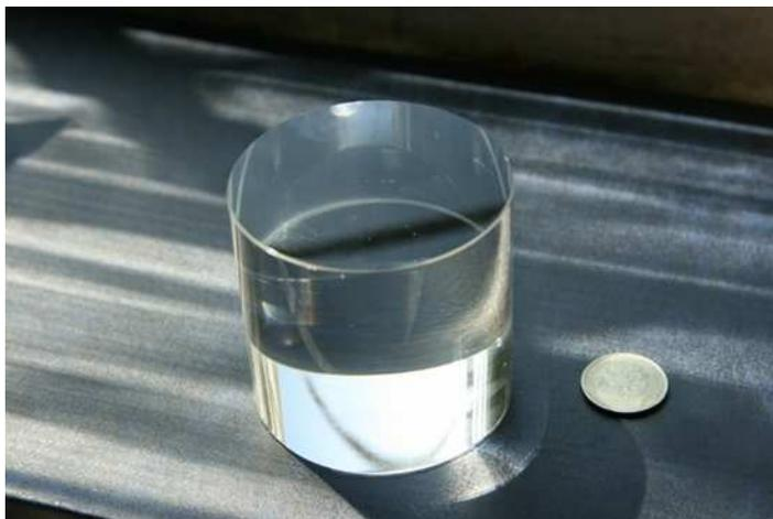
**Рис. 111.** Кристалл  $\text{BaF}_2\text{-LaF}_3$  размером 63×63 мм
