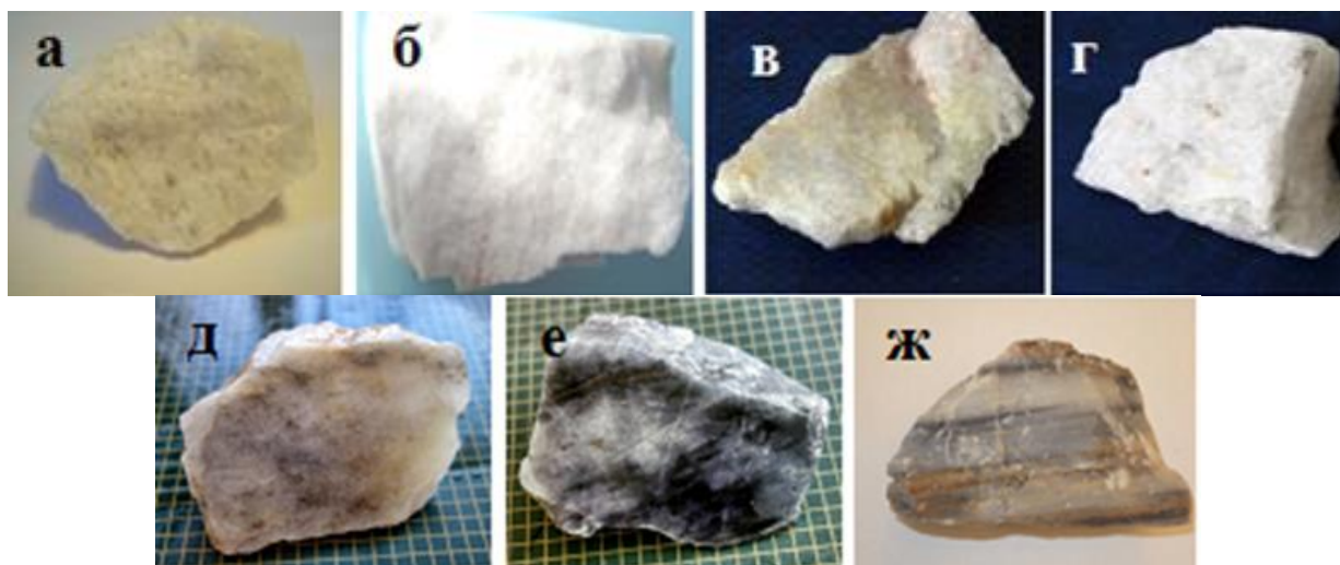
Рисунок 25 – Образцы кварцевого материала: а-г – Ока-Урикский блок; а- суперкварциты, б-мелкозернистые кварциты, в-сливной кварцит, г-крупнозернистый кварц, д- кварциты первого типа Урда-Гарганского блока, е- кварциты второго типа Урда-Гарганского блока, ж - кварциты Уренгенурского блока
