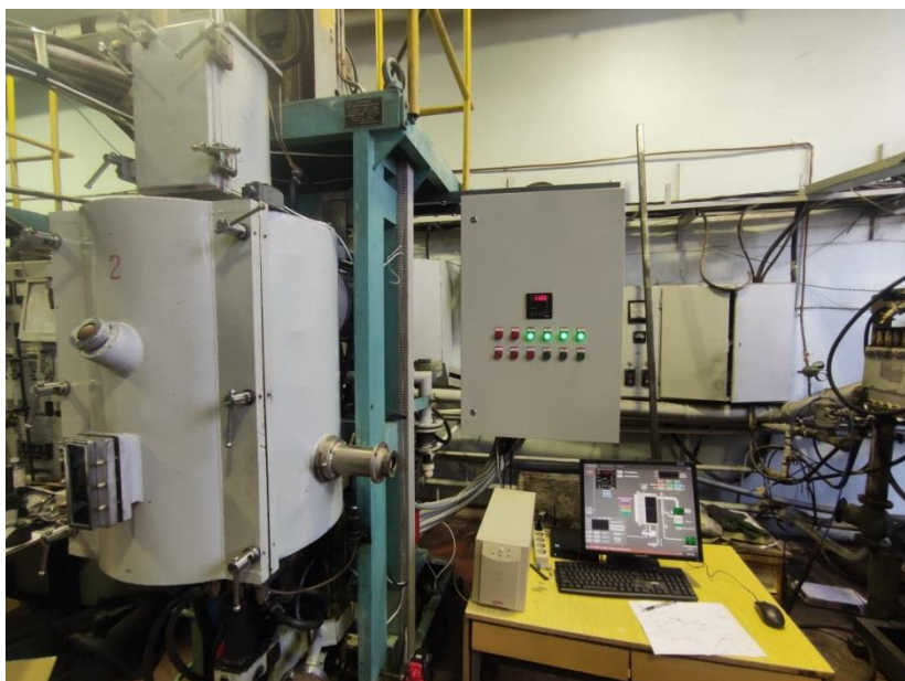
Рисунок 3 – Модернизированная ростовая установка СЗВН-20
