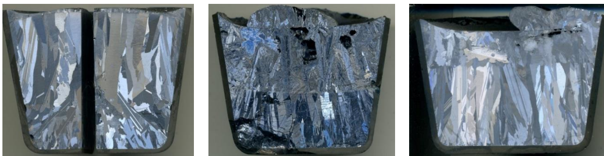
Рисунок 47 – Сканированные изображения продольных распилов слитков КРС199, КРС200, КРС201 (слева-направо)
