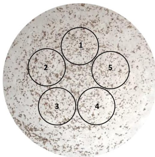
Рисунок 1.1.1 – Распределение частиц порошка циркона на плёнке из полипропилена. Нумерованные круги соответствуют 5-ти областям измерения
