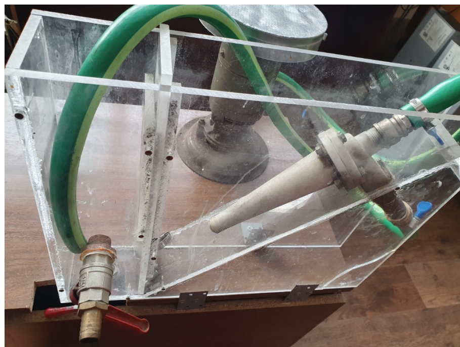
Рисунок 3.9 – Флотомашина с пневмогидравлическим аэратором
