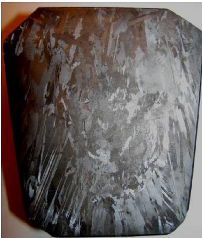
*Рис. 1.* Кристалл мультикремния с концентрационным переохлаждением
