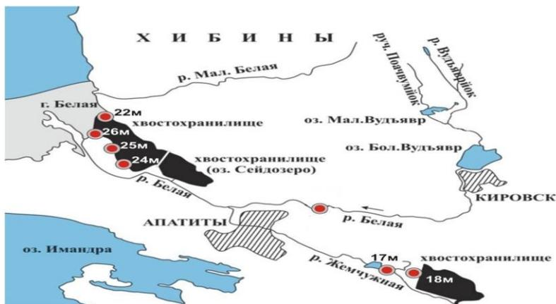
Рисунок 6 — Схема расположения поверхностных вод и скважин подземных вод: хвостохранилище АНОФ-2 - Скважины 22м, 26м, 25м, 24м.
