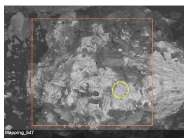
Рис. 17. Морфология и химический состав галенита из массива техногенных хвостов.
