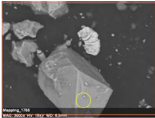
Рис. 2.72. Химический состав первичного магнетита. СЭМ, изображение в обратно рассеянных электронах, с результатами энергодисперсионного микроанализа.
