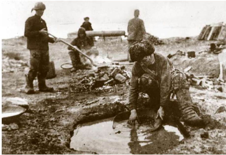
Рис. 5.2. Извлечение золота с применением простейшей кустарной технологии амальгамации золотоносных руд [162].
