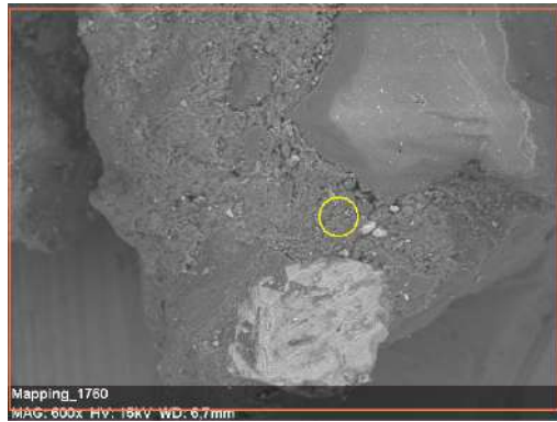
Рис. 2.80. Химический состав аморфной глинисто-железистой массы. СЭМ, изображение в обратно рассеянных электронах, с результатами энергодисперсионного микроанализа.
