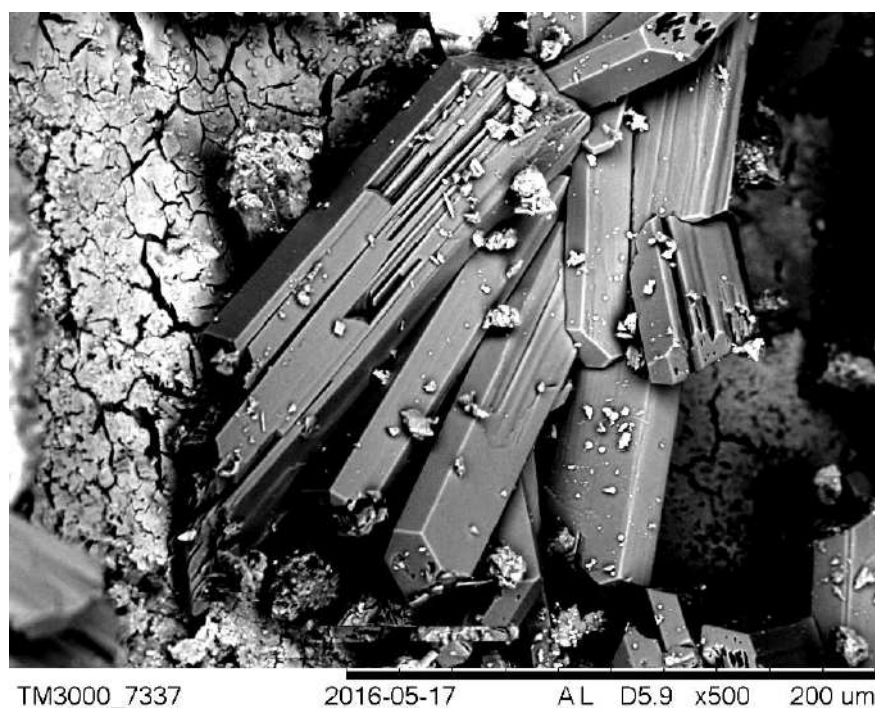
Рис. 4.52. Морфологические особенности кристаллов гипса. СЭМ, изображение в обратно рассеянных электронах.
