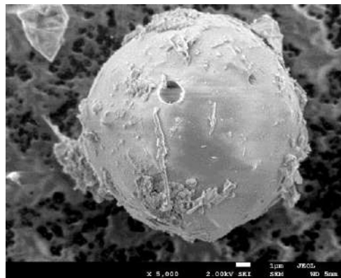
Рис. 2.15. Распределение вторичных карбонатных минеральных фаз на поверхности алюмосиликатных глобул. Сканирующая электронная микроскопия (СЭМ), изображение в обратно рассеянных электронах.
