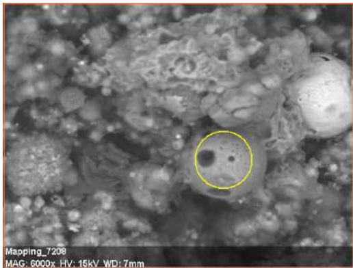
Рис. 2.16. Химический состав ферритовых (а) и алюмосиликатных (б) глобул. СЭМ, изображение в обратно рассеянных электронах, с результатами энергодисперсионного микроанализа.
