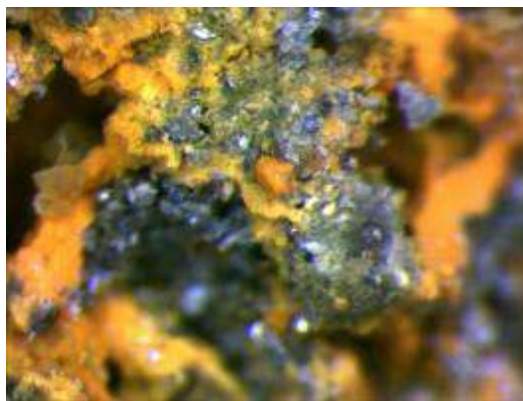
Рис. 4.38. Самородная сера, цементирующая обломки сульфидов и горных пород в лежалых хвостах. Бинокулярный микроскоп, отраженный свет. Увел. 56,9^{\times} (МБС-10).
