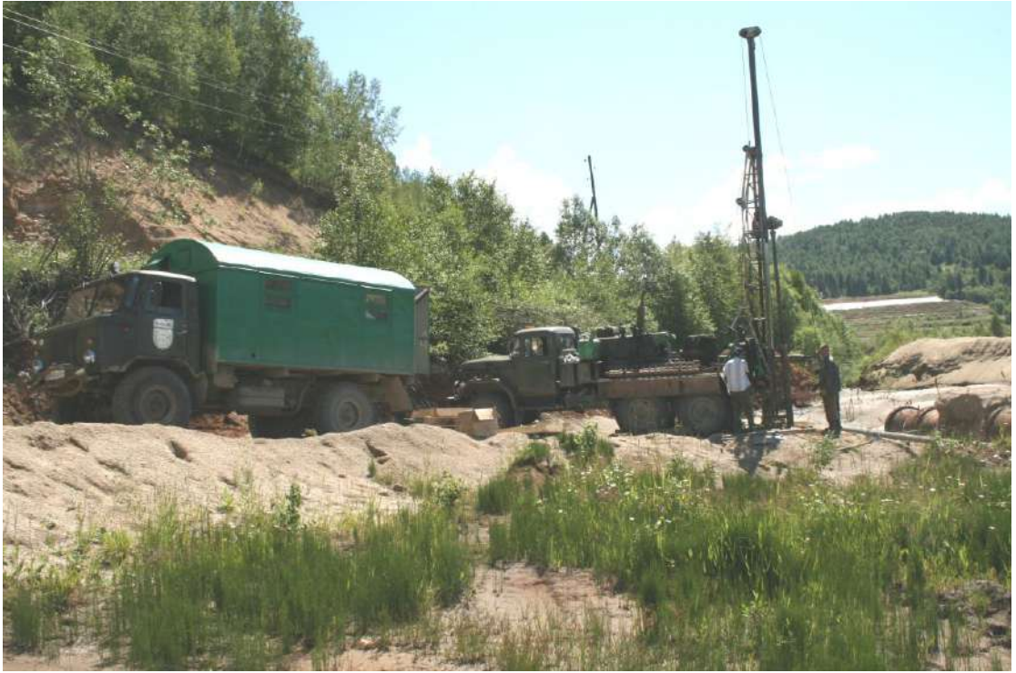
Рис. 1.6. Бурение колонковой скважины на пляжной зоне хвостохранилища Артемовской ЗИФ.
