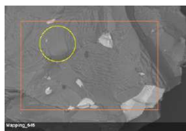
Рис. 5.24. Морфология и химический состав галенита (а), сфалерита (б) из массива техногенных хвостов.
