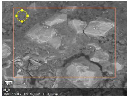
Рис. 4.60. Химический состав аморфной глинисто-железистой массы, цементирующей обломочный материал хвостов. СЭМ, изображение в обратно рассеянных электронах, с результатами энергодисперсионного микроанализа.
