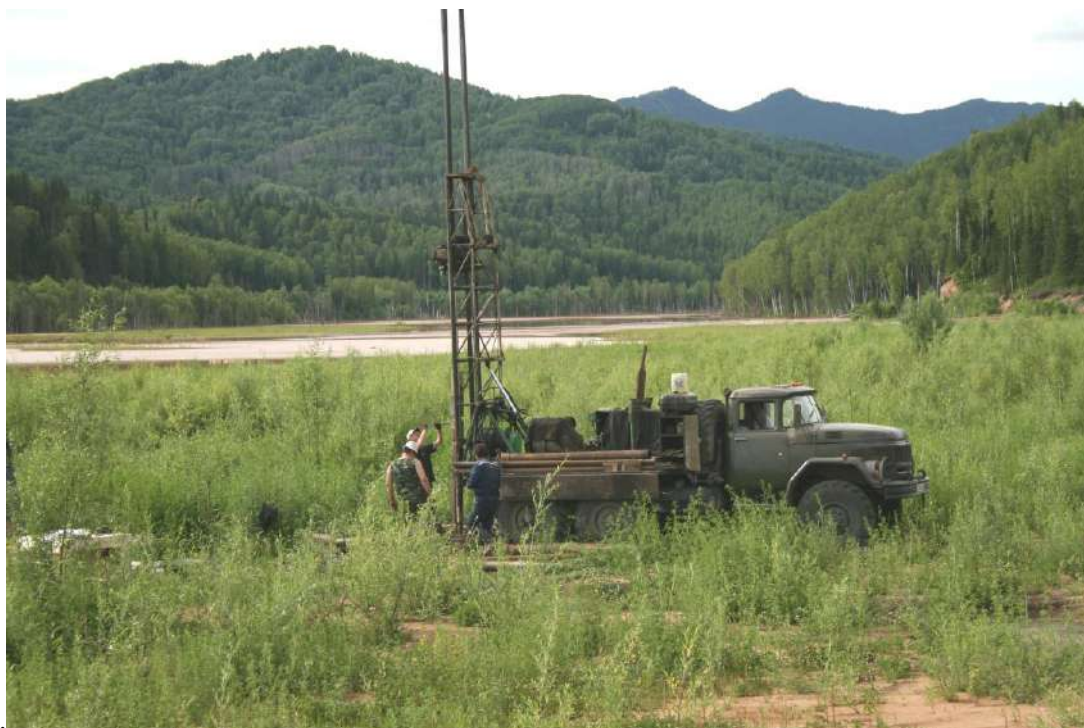
Рис. 1.8. Бурение колонковой скважины на пляжной зоне хвостохранилища Краснокаменского ГОКа.
