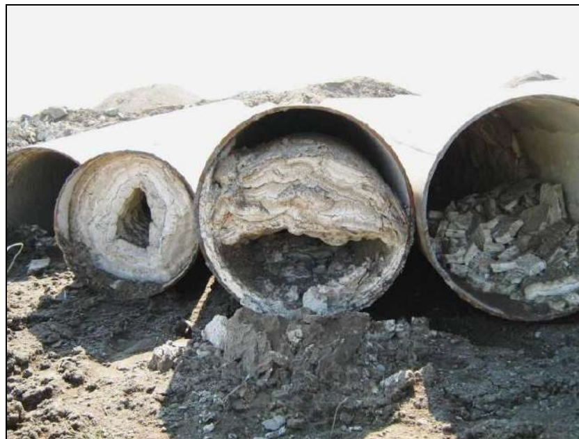
Рис. 2.26. Новообразованные минеральные фазы в дренажных системах золоотвала Назаровской ГРЭС (диаметр труб 700 мм).
