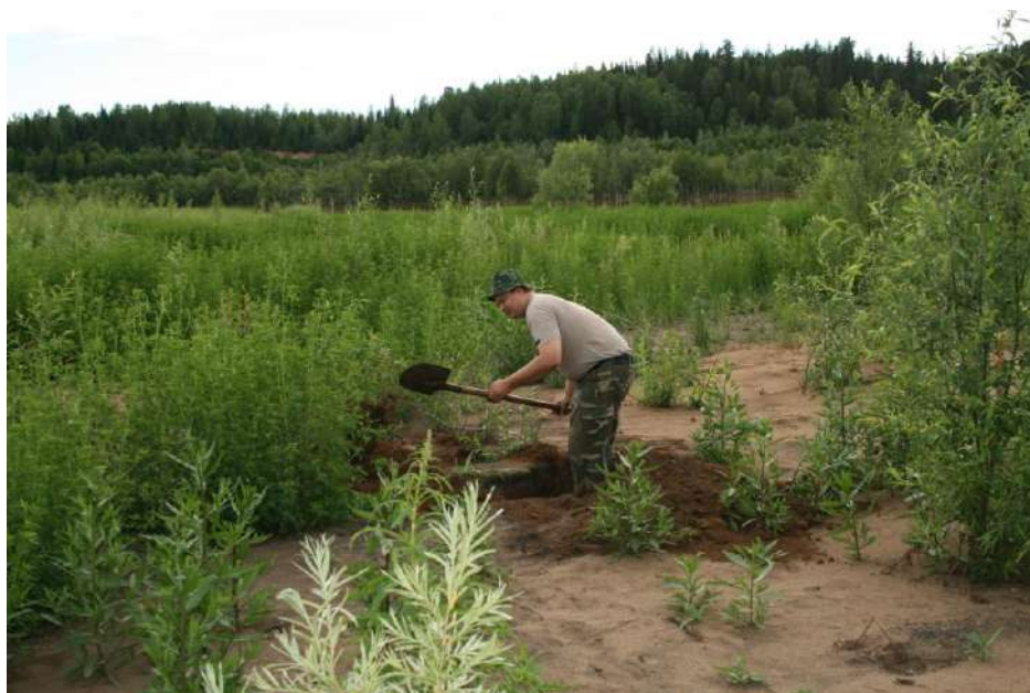
Рис. 1.2. Вскрытие пляжной зоны шурфом на хвостохранилище Краснокаменского ГОКа.
