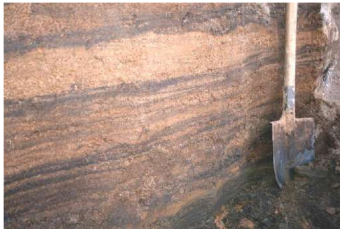
Рис. 2.60. Градационная слоистость лежалых хвостов в хвостохранилище Краснокаменского ГОКа.
