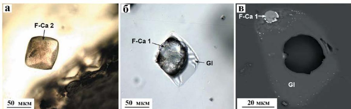
Рис. 6.8. а-б – включения F-Ca фазы в кварце, до прогрева; в – глобула F-Ca фазы в РВ, после нагрева, BSE. Проходящий свет. F-Ca 2 – поздняя, раскристаллизованная генерация F-Ca фазы.
