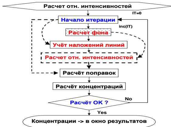
Рис 2. Алгоритм учета фона: тормозного и характеристического в итерационном цикле расчета концентраций
