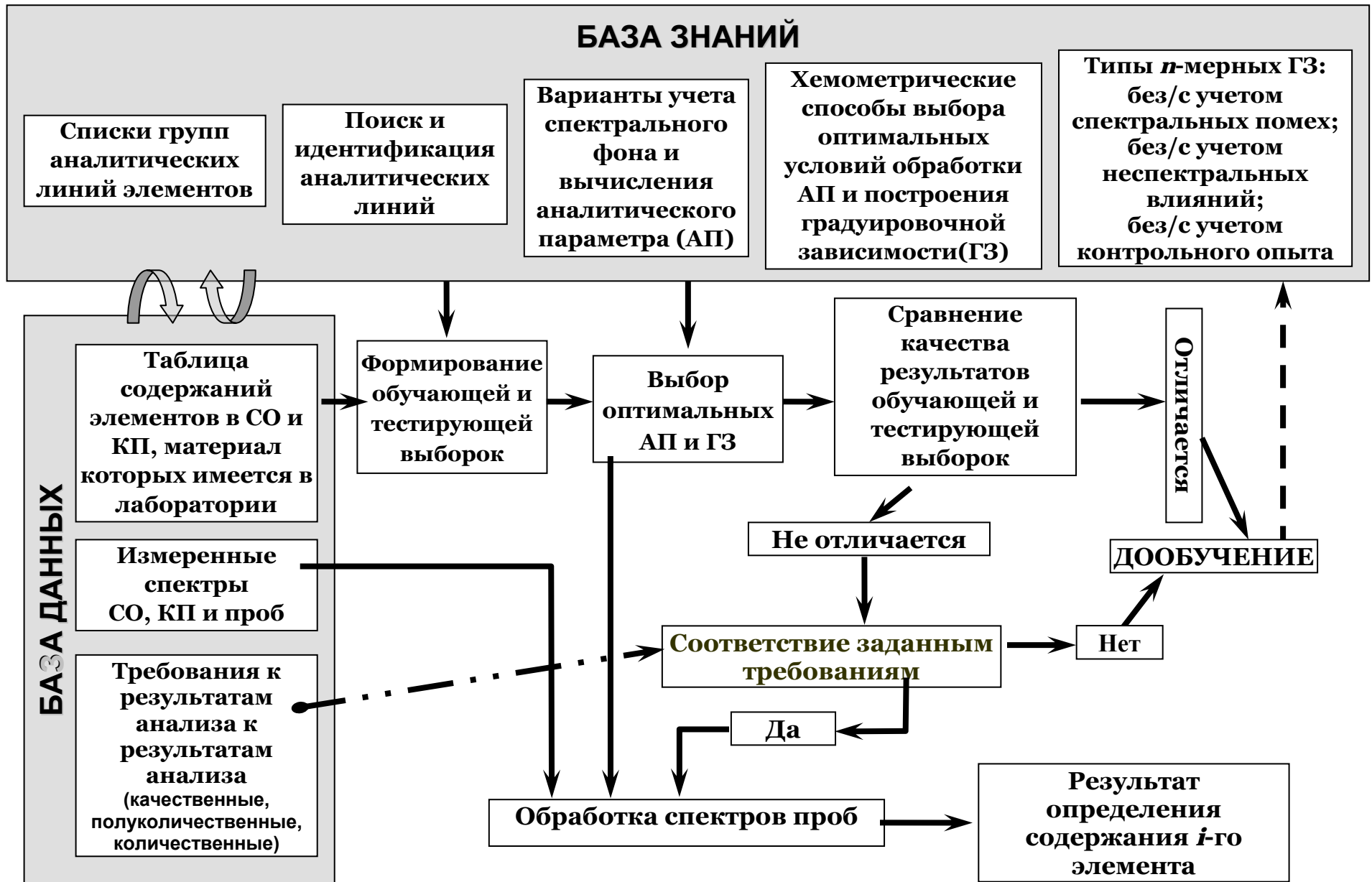
Рис. 5. Концептуальная модель и схема функционирования системы компьютерной интерпретации дуговых атомно-эмиссионных спектров
