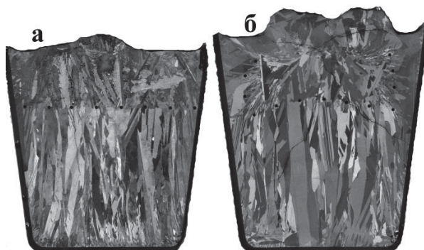
Рис. 25. Границы областей столбчатого роста и быстрой заморозки в слитках из кремния чистоты 99,999999 ат.% (а) и кремния чистоты 99,76 ат.% (б), выращенных: 1) со скоростью опускания тигля 0,5 см/ч без вращения (а); 2) со скоростью опускания тигля 1,5 см/ч и вращением – 6 об/мин (б)
