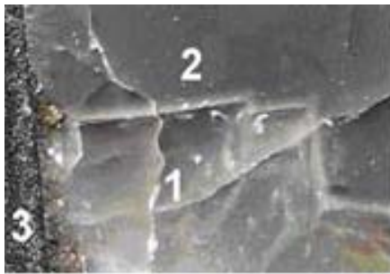
Рис.18. Рост кристалла БИ (1) из расплава (2) в Ag-атмосфере. 3 - графитовый тигель.
