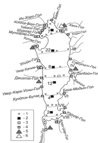
Рис. 4.3. Схема отбора проб в оз. Хубсугул и Прихубсугулье (1 – вода, 2 – донные отложения озера, 3 – вода притоков, 4 – русловые отложения притоков, 5 – почва, 6 – снег).
