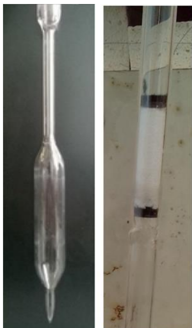
Рис.8. Кварцевая ампула, состоящая из двух объемов. Слева ростовой объем, справа объем с кварцевым фильтром для фильтрации исходных соединений.
