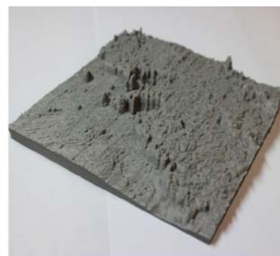
Поверхность синтетического кристалла пирита, АСМ (3.75 мкм × 3.75 мкм × 230 нм)
