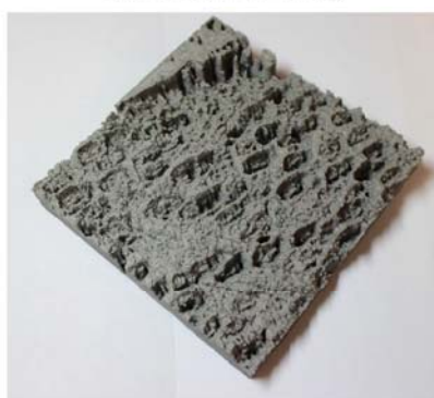
Пирит со следами «контактного наведения», АСМ (1.9 мкм × 1.9 мкм × 250 нм)
