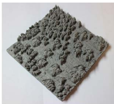
Поверхность синтетического кристалла галенита, АСМ (2.5 мкм × 2.5 мкм × 72 нм)
