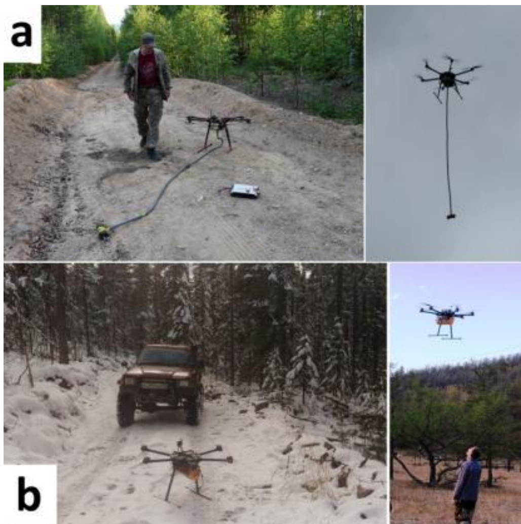
Рисунок 2 – Магниторазведочный (а) и гамма-спектрометрический (б) варианты комплекса SibGIS UAS
